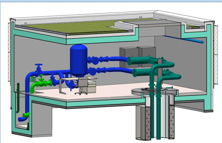
*3D Plan des neuen Grundwasserpumpwerks.*
