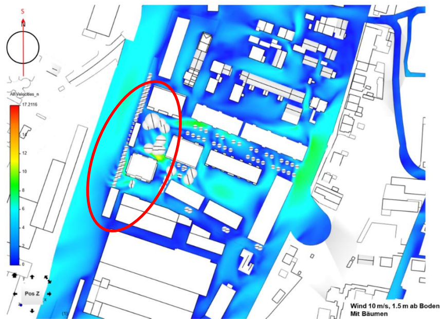
Abbildung 12: Windgeschwindigkeit im Areal bei Südwind 10 m/s, 1.5 m ab Boden mit Bäumen
