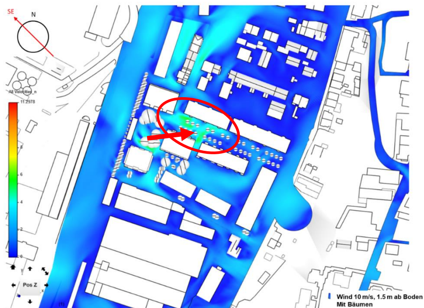
Abbildung 16: Windgeschwindigkeit im Areal bei Südostwind 10 m/s, 1.5 m ab Boden mit Bäumen
